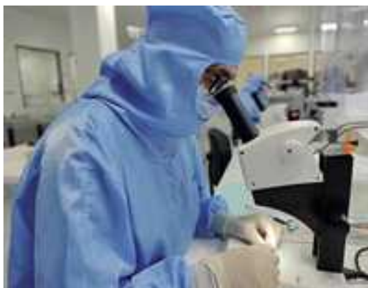
Contrôle visuel d'un composant en salle ISO 7 après surmoulage epoxy
